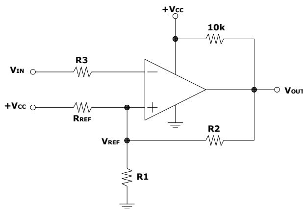
$$R_2 \gg R_{REF} \parallel R_1$$
