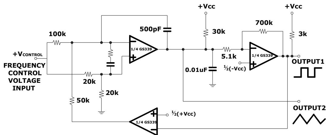
$+250\text{mV} \leq V_c \leq +50\text{V}$  ;  $700\text{Hz} \leq f_0 \leq 100\text{kHz}$
