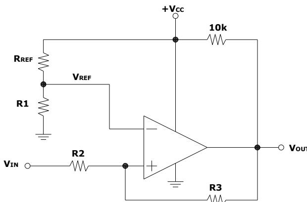
$$R_2 \doteq R_{REF} \parallel R_1$$
